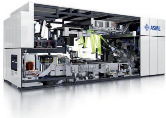
Abbildung 82: Beispiel eines ASML-Lithographiegerätes. Einige große Herausforderungen für ASML-Lithographiemaschinen: sehr genaues, ultraschnelles und ultrakleines Linienschreiben auf Siliziumscheiben, die sich in Computerchips verwandeln sollen. Quelle: ASML
