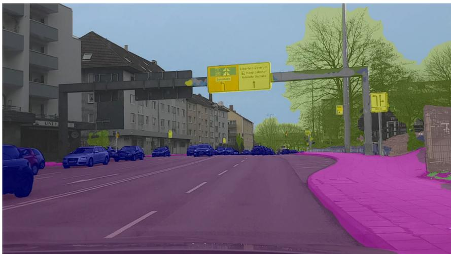
Abbildung 61: Beispiel einer sogenannten semantischen Segmentierung, berechnet von einem tiefen neuronalen Netz. Für jedes Bildpixel wird eine Klassenzugehörigkeit geschätzt, durch eine Zuordnung von Klassen zu Farben entsteht ein solches Segmentierungsbild.
