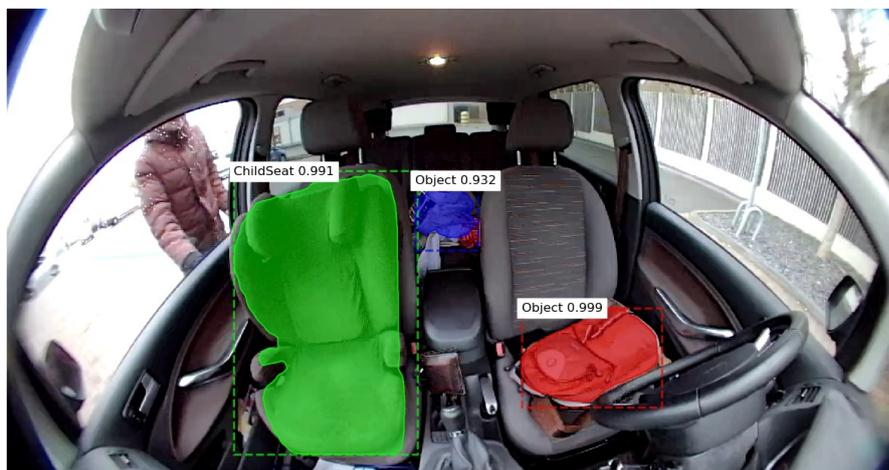
Abbildung 63: Beispiel einer Instanzsegmentierung im Innenraum eines Autos. Zuerst werden Objekte lokalisiert und von Rechtecken umrandet. Anschließend wird die Instanz innerhalb des Rechtecks segmentiert.
